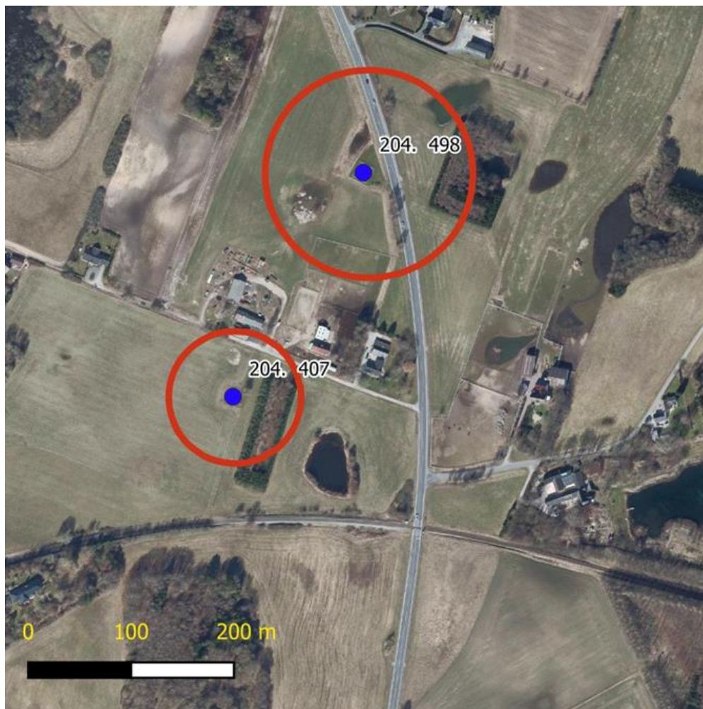
Figur 6.24. BNBO tilhørende Ruds Vedby Vandværk's to indvindingsboringer med DGU nr. 204.498 og 204.407.
