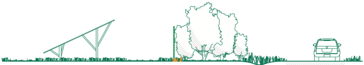
Figur 5: Principsnit af solceller, hegn/beplantningsbælte og vej
