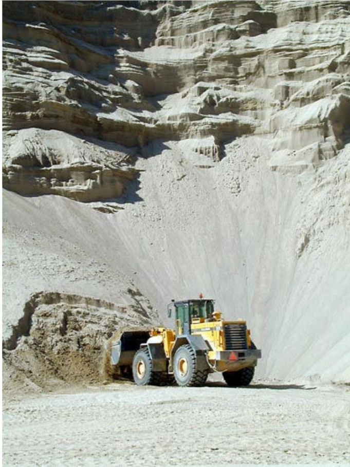
Figur 3.3.19: Gummihjulslæsser – gravning ved gravefront.
