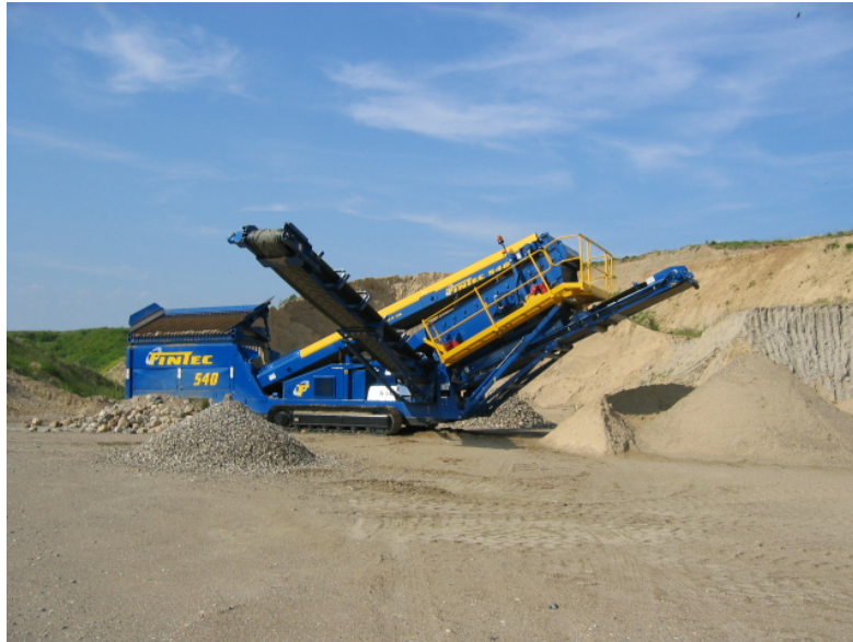
Figur 3.3.20: Tørsortering af materialerne foregår med et mobilt tørsorteringsanlæg.
